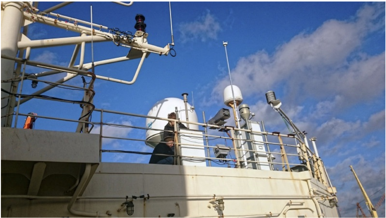
Die Messtechnik zur Probenahme für Aerosole und Wolken wurde an der Reeling des russischen Forschungseisbrechers "Akademik Tryoshnikov" angebracht. Foto: Silvia Henning, TROPOS
