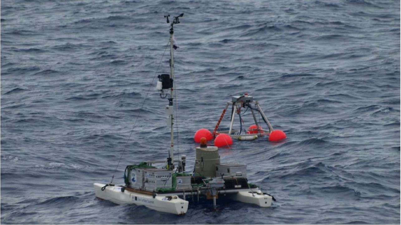
Zum Einsatz kommen eine sensorbestückte Spezial-Driftboje und ein ferngesteuerter Forschungskatamaran. Foto: Dr. Oliver Wurl/ ICBM
