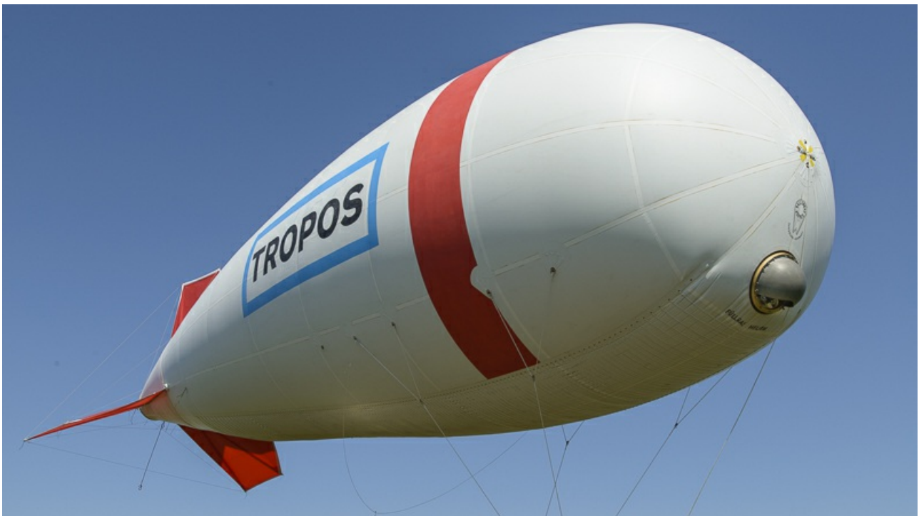
TROPOS-Zeppelin zur Messung in bodennahen Luftschichten der Arktis (Foto: Tilo Arnhold / TROPOS).
