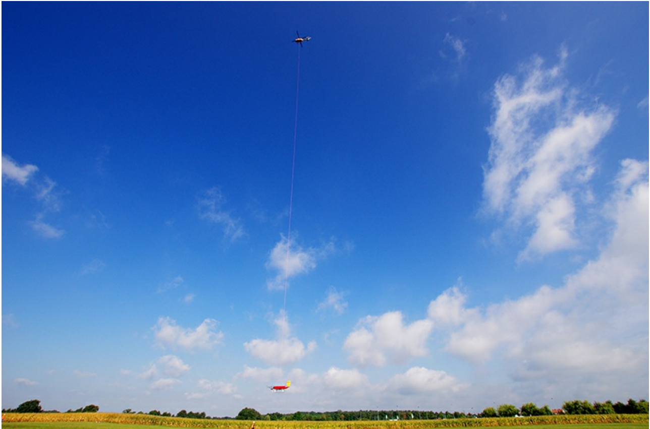
Die mit verschiedensten Sensoren ausgestattete Hubschrauberplattform ACTOS und der Schleppkörper SMART-Helios werden hängen an einem langen Seil und werden per Hubschrauber zu den Wolken gebracht. Foto: Holger Siebert, TROPOS
