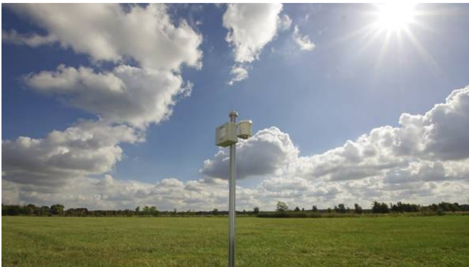
Strahlungsmessungen mit Pyranometern. Foto: Patric Seifert, TROPOS
