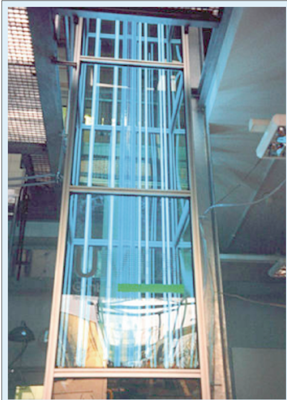
Abb. 6: Der laminare Rohrreaktor des IFT.
