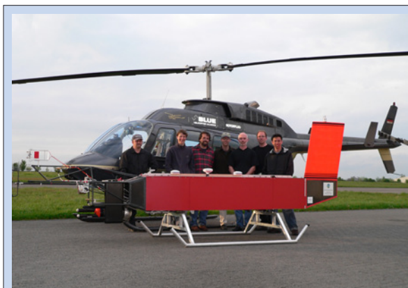
Fig. / Abb. 9: First application of helicopter-borne ACTOS (Airborne Cloud Turbulence Observation System) in Koblenz/Winningen 2005. / Erster Hubschraubereinsatz mit ACTOS in Koblenz/Winningen 2005.
