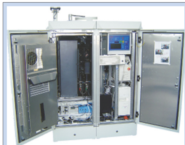
Fig. / Abb. 11: Mini Raman lidar polly in an air-conditioned cabinet. / Mini Raman lidar polly im klimatisierten Gehäuse.
