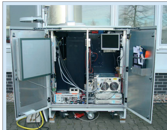
Fig. / Abb. 12: Mini Raman lidar Polly XT in an air-conditioned cabinet. / Mini-Ramanlidar Polly XT im klimatisierten Gehäuse.
