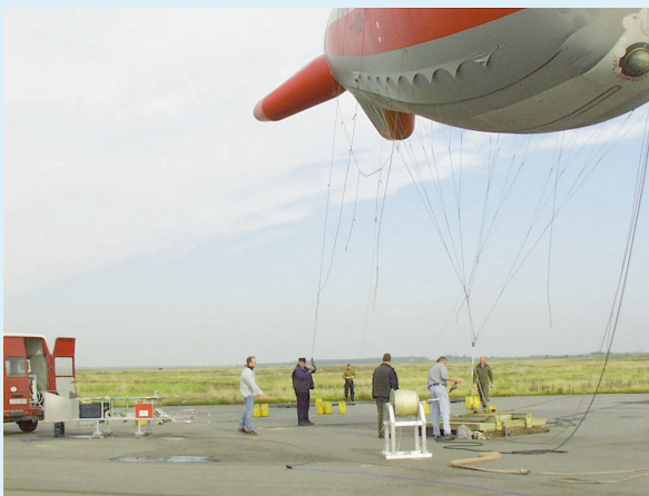
Abb. 4: Fesselballonmessungen an der Nordseeküste.
