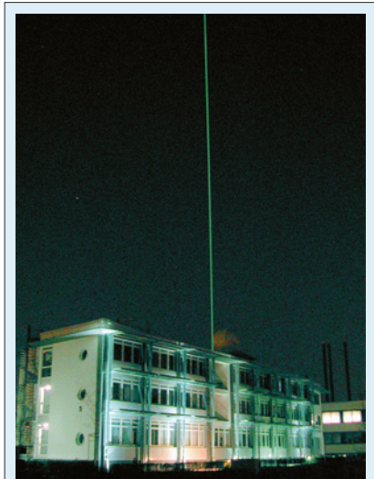
Abb. 5: Mehrwellenlängen-Raman-Lidarmessung im Rahmen des Europäischen Lidarnetzwerkprojekts EARLINET.
