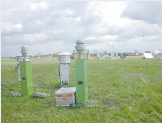
Abb. 2: Partikelsammler während des Feldexperiments INTERCOMP 2000 auf der Forschungsstation Melpitz.
