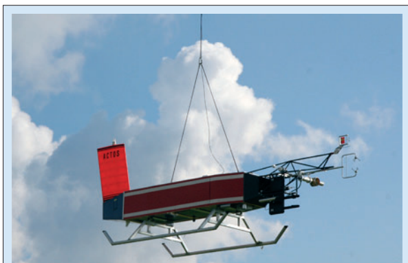
Fig. / Abb. 8: The helicopter-borne payload ACTOS approaching airport Kiel-Holtenau. / Die hubschraubergestützte Messplattform ACTOS kurz vor der Landung auf dem Flugplatz Kiel-Holtenau.
