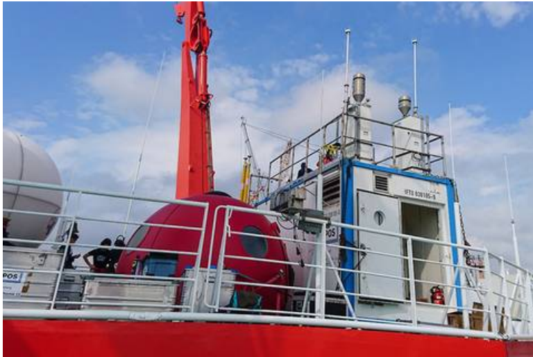
Damit die Luftanalysen möglichst unbeeinflusst vom Schiff sind, steht der entsprechende Container vorn auf dem Peildeck.
