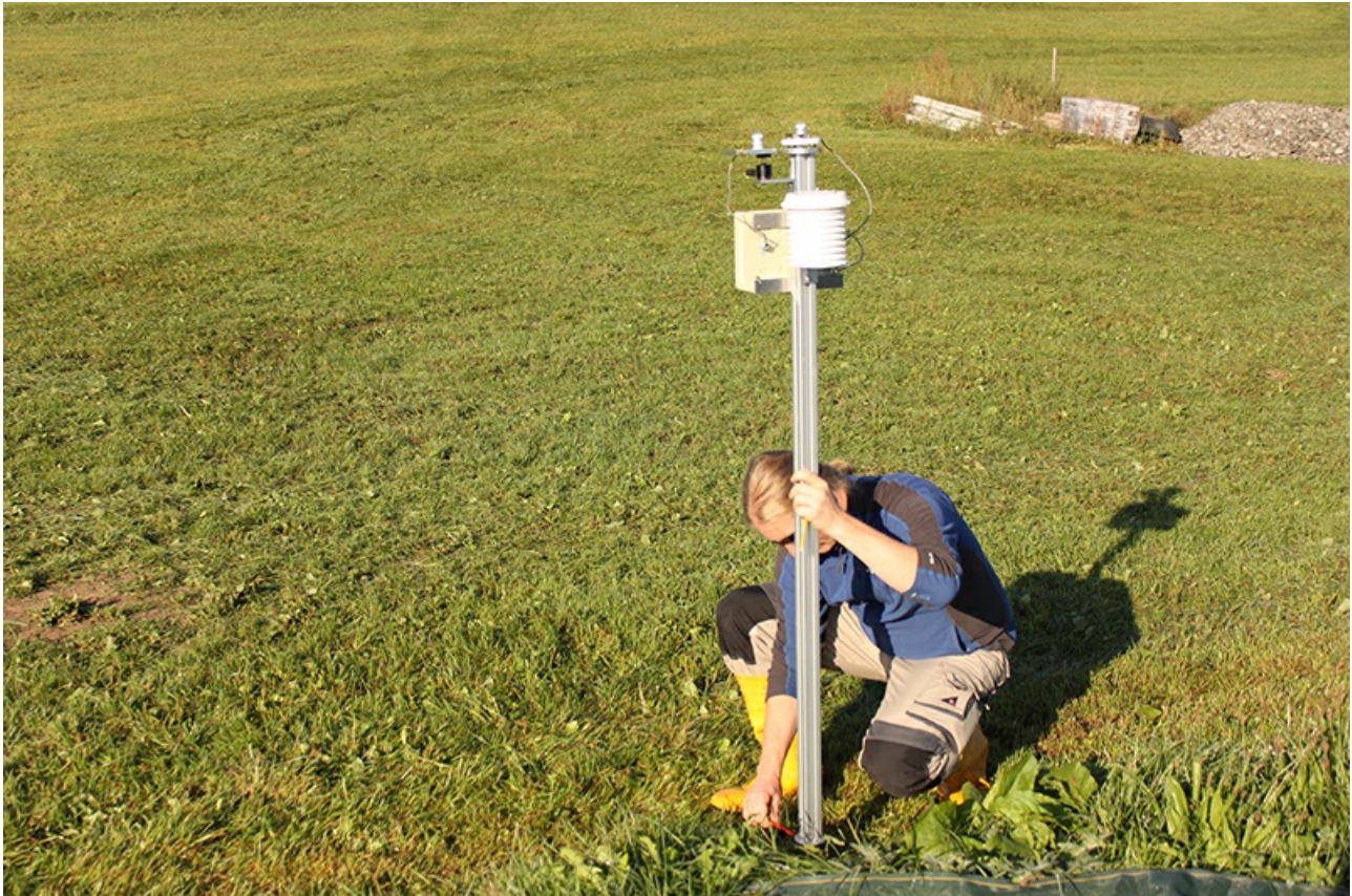
Das Pyranometernetz ist ein wichtiger Baustein, um die Schwankungen in der Sonneneinstrahlung und der erzeugten Solarenergie besser zu verstehen. Foto: Jonas Walther, TROPOS
