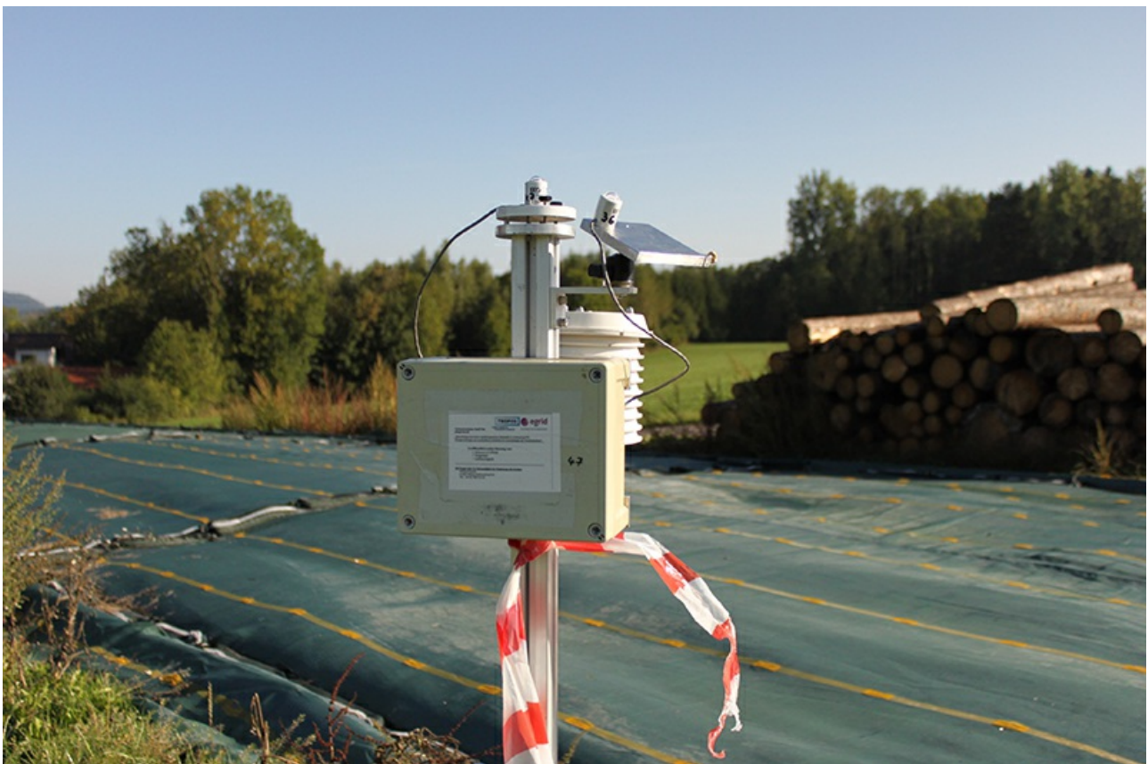
Für die Kampagne im Allgäu wurden die Messstationen so modifiziert, dass ein zusätzlicher Sensor die Sonnenenergie erfasst, die auf der geneigten Fläche der Photovoltaik-Module auftrifft. Damit wird ein wichtiger Einflussfaktor auf die produzierte Strommenge erfasst. Foto: Jonas Walther, TROPOS
