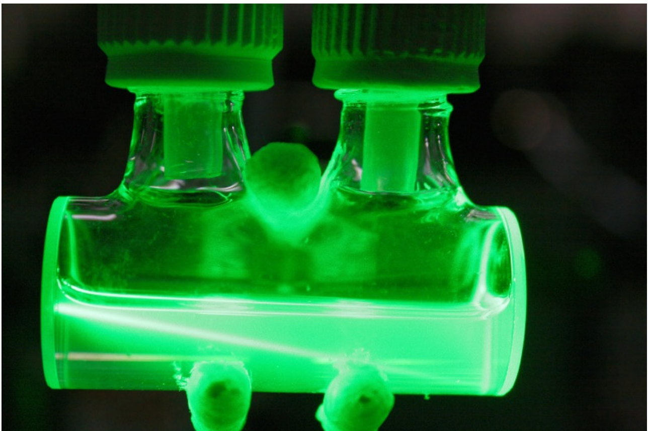
Im Labor des IRCELYON in Lyon wurde von der Gruppe um Dr. Christian George das Meerwasser künstlich beleuchtet und die dabei entstehenden Gase analysiert, um die photochemischen Prozesse an der Schnittstelle zwischen Meereswasser und Atmosphäre zu untersuchen. Foto: IRCELYON
