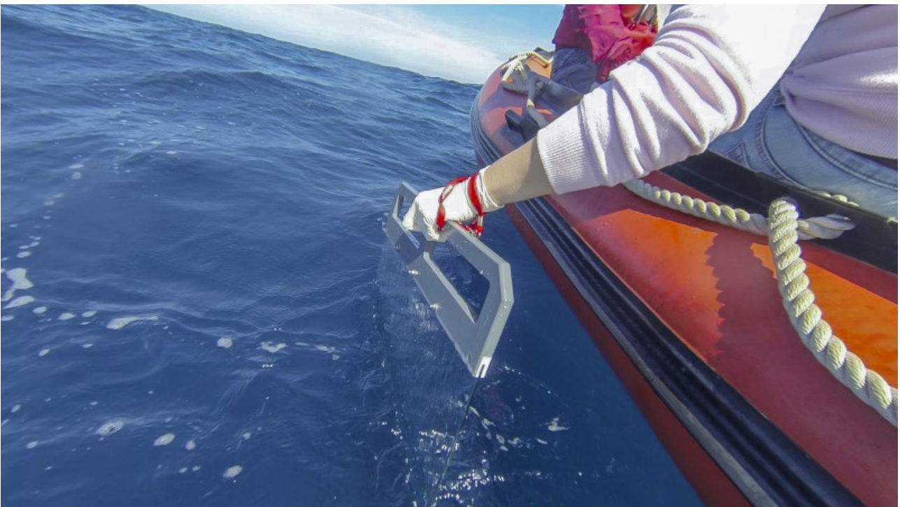
Der Oberflächenfilm wurde von der Leipziger Wissenschaftlerin Dr. Manuela van Pinxteren im Nordatlantik mit der Glasplattentechnik eingesammelt. Foto: Tilo Arnhold/TROPOS
