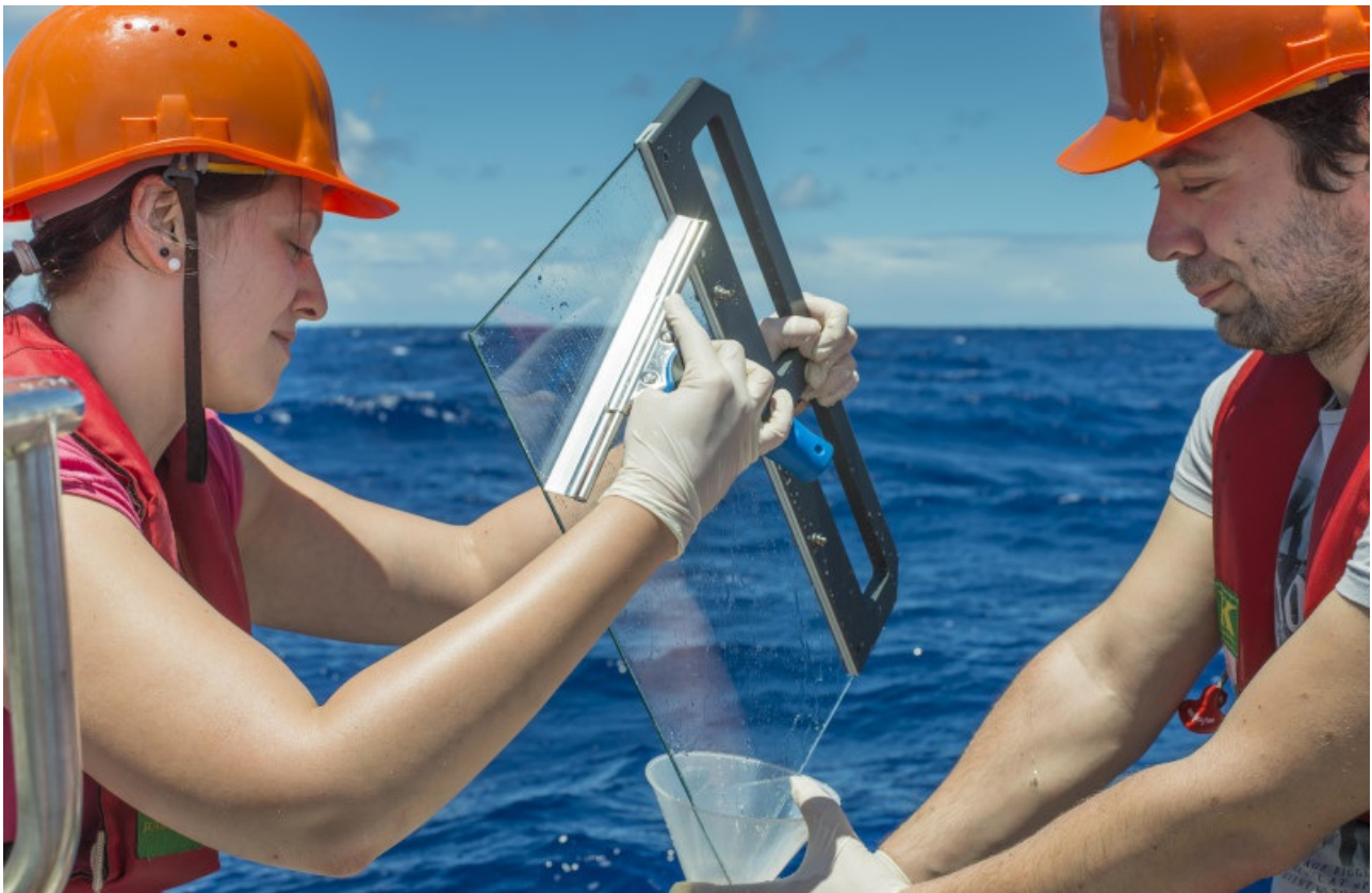
Zur Probenahme wird eine Glasplatte ins Wasser getaucht und anschließend wieder vorsichtig aus dem Wasser gezogen. Dabei bleibt der 200 Mikrometer dünne Oberflächenfilm am Glas haften und wird anschließend mit einem Scheibenwischer abgekratzt. (Im Foto: Susanne Fuchs und Maik Merkel vom TROPOS während der Polarstern-Expedition PS83 im Atlantik.) Foto: Hartwig Deneke/TROPOS
