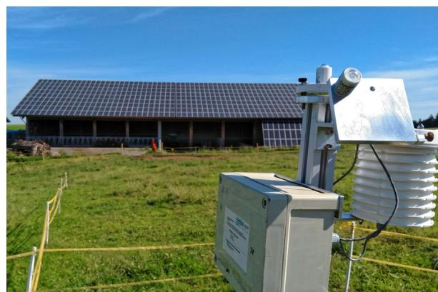
*Fig. / Abb. 11: MetPVNet measurement campaign in Allgäu: Analyses of the influence of aerosols on the yield of photovoltaic systems contribute to making the energy transition more secure. / MetPVNet-Messkampagne im Allgäu: Analysen zum Einfluss von Aerosolen auf den Ertrag von Photovoltaik-Anlagen helfen, die Energiewende sicherer zu machen. (Photo: Jonas Witthuhn / TROPOS)*
