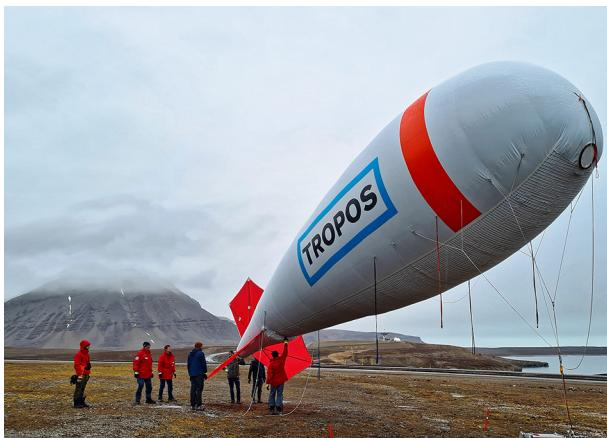
Fig. / Abb. 12: Following the successful MOSAiC expedition, the BELUGA tethered balloon was deployed in Ny-Ålesund on Svalbard at the end of 2020. TROPOS and the University of Leipzig took measurements in the polar night for the first time. / Nach der erfolgreichen MOSAiC-Expedition kam der BELUGA-Fesselballon Ende 2020 in Ny-Ålesund auf Spitzbergen zum Einsatz. TROPOS und Universität Leipzig haben dabei erstmals in der Polarnacht gemessen. (Photo: André Ehrlich, Universität Leipzig)
