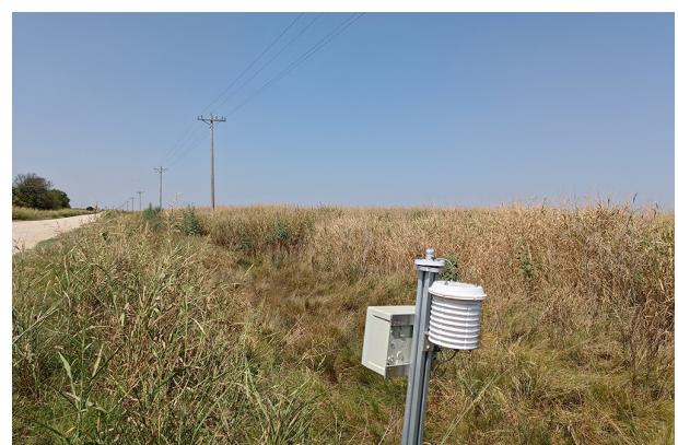
*Fig. / Abb. 11: The PyrNet devices from TROPOS measured global radiation, temperature and humidity during the S2VSR campaign in the fields of Oklahoma. / Die PyrNet-Geräte vom TROPOS haben bei der Kampagne S2VSR in den Feldern Oklahomas Globalstrahlung, Temperatur und Luftfeuchtigkeit gemessen. (Photo: Oscar Ritter / TROPOS)*
