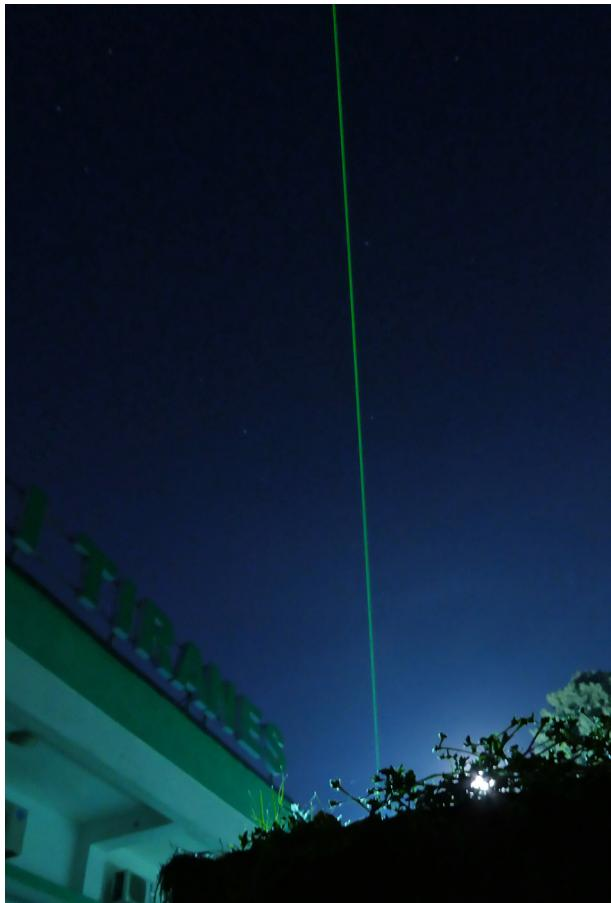
*Fig. / Abb. 15: In November 2022, the green beam of a Polly lidar was seen over Tirana for the first time. The measurements are the first of their kind in Albania. / Im November 2022 war erstmals der grüne Strahl eines Polly-Lidars über Tirana zu sehen. Die Messungen sind die ersten ihrer Art in Albanien. (Photo: Dietrich Althausen, TROPOS)*
