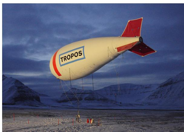
Fig. / Abb. 13: Tethered balloon BELUGA in Ny-Ålesund on Svalbard during the international HALO-(AC)3 research campaign to study changes in air masses in the Arctic. / BELUGA-Fesselballon in Ny-Ålesund auf Svalbard während der Kampagne HALO-(AC)3 zur Untersuchung von Luftmassen-Wechsel in der Arktis. (Photo: Holger Siebert / TROPOS)
