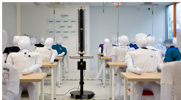
Fig. / Abb. 13: Classroom laboratory of the BeCoLe indoor air project at NEL Leipzig. / Klassenzimmer-Labor des Innenraumluftprojektes BeCoLe bei NEL Leipzig. © Katrin Haase, HTWK
