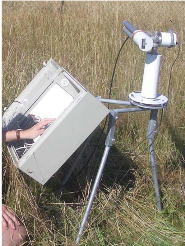
**Abbildung 3.4:** Ein Sonnenphotometer entwickelt von Cimel Elektronik (<http://www.uni-trier.de/index.php?id=28930>).
