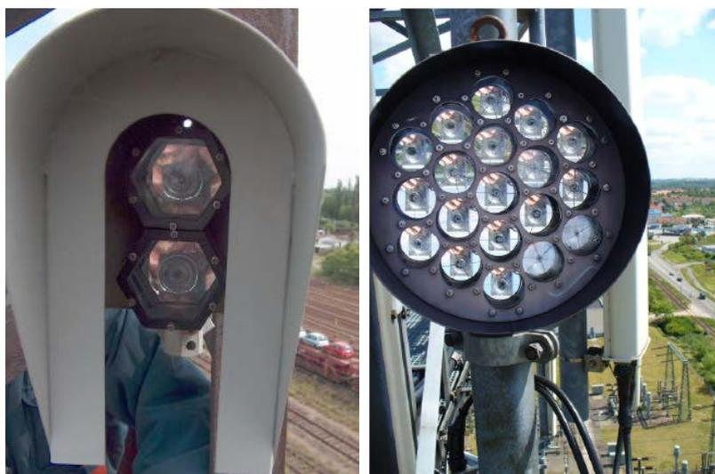
**Abbildung 3.3:** Retroreflektoreinheiten. Links: Retroreflektoreinheiten der Referenzstrecke am DB-Mast, Rechts: Retroreflektoreinheiten der Messstrecke am E-Plus-Mast. Fotos: R. Dubois, U. Geburtig.
