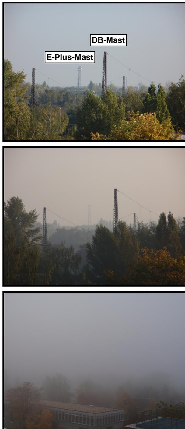
**Abbildung 3.5:** Fotografien der Messstrecke bei unterschiedlichen Sichtverhältnissen. **(Oben)** Höhere Sichtweite, Referenzmast (DB-Mast) und Messmast (E-Plus-Mast) sind deklariert. **(Mitte)** Niedrige Sichtweite. **(Unten)** Sehr niedrige Sichtweite (< 300 m), sowohl Mess- als auch Referenzstrecke sind mit bloßem Auge nicht zu erkennen. Quelle Fotos: A. Skupin.
