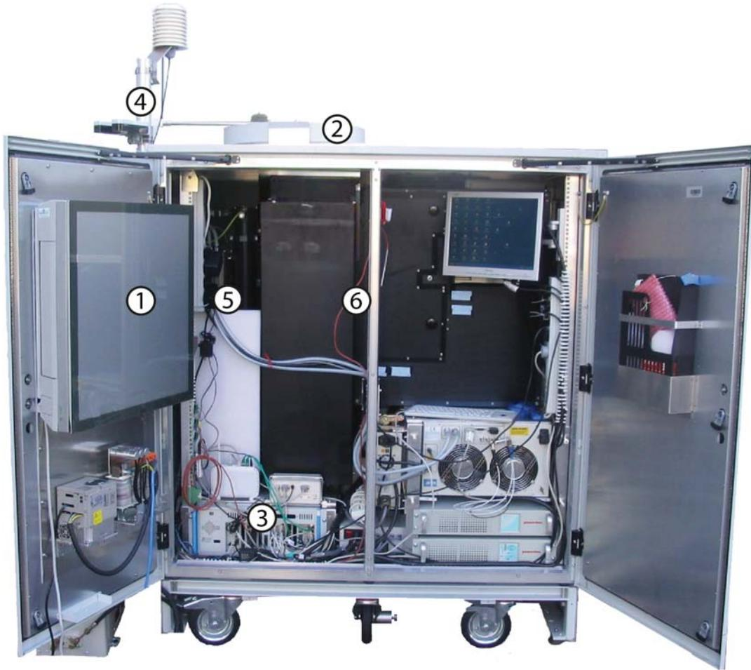
Abbildung 4.2: Polly<sup>XT</sup> geöffnet mit seinen Komponenten: (1) Klimaanlage, (2) Abdeckung, (3) Computer mit Datenerfassung, (4) Sensor für Außentemperatur, Luftdruck und Regen, (5) Sender und (6) Empfänger [Althausen *et al.*, 2009].
