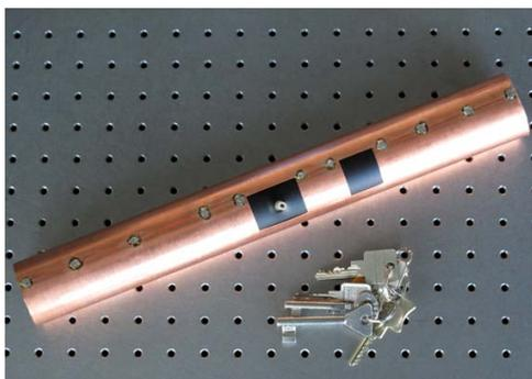
(a) Befüllte Glasküvette mit geschwärztem Rohr und Kupfermantel.
