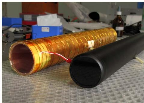
(b) Zwei befüllte Glasküvetten. Links mit Kupfermantel und Widerstandsheizung. Rechts mit Schwärzung des Rohrs.
