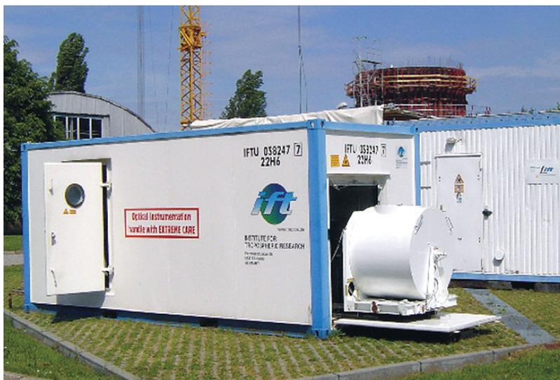
**Abbildung 4.7.:** Raman-Lidar BERTHA des IfT Leipzig. Im Vordergrund auf der geöffneten Luke des Containers die Spiegel zur Aussendung des Laserstrahls in die Atmosphäre und zur Umlenkung des rückgestreuten Lichts in den Empfänger. Bild von D. Althausen (IfT).
